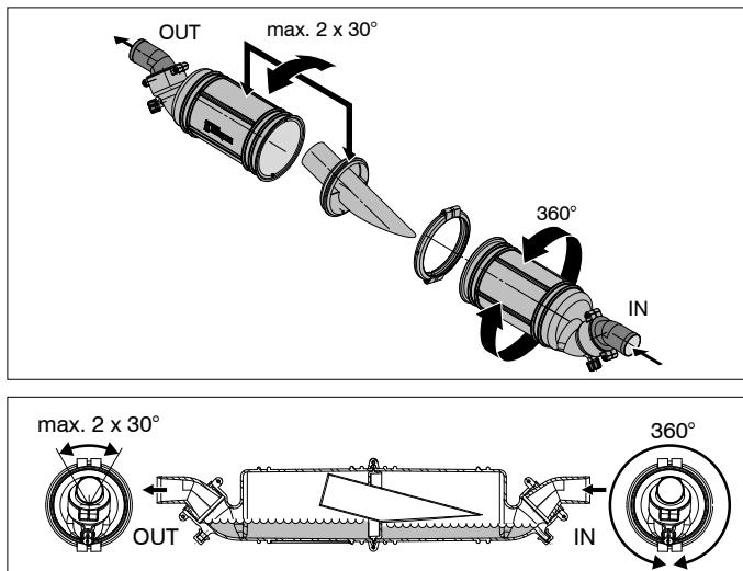
Voor een goede werking is het noodzakelijk dat de OUT (UIT) huishelft en het hierin geplaatste binnendeel in de getekende stand staat. Een verdraaiing van maximaal 30° naar elke kant is toegestaan. De IN huishelft mag in elke stand worden geplaatst.
