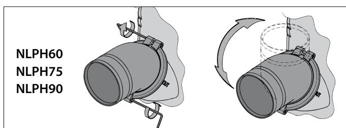
**¡Soltar las tornillos antes de girar las conexiones de manguera!**
