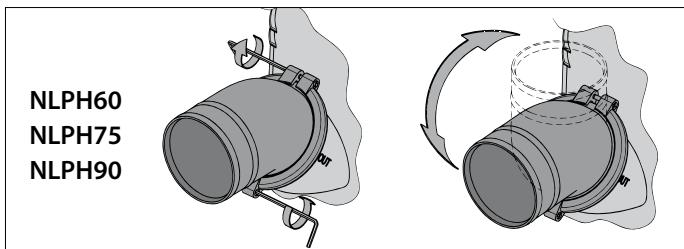
**Draai de bouten los alvorens de slangaansluitingen te verdraaien!**
