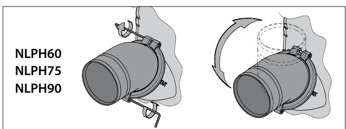
Lösen Sie die Bolzen, bevor Sie die Schlauchverbindungen drehen! Schrauben Sie die Schlauchverbindungen mit einem Anzugsmoment von 1 Nm wieder fest.
