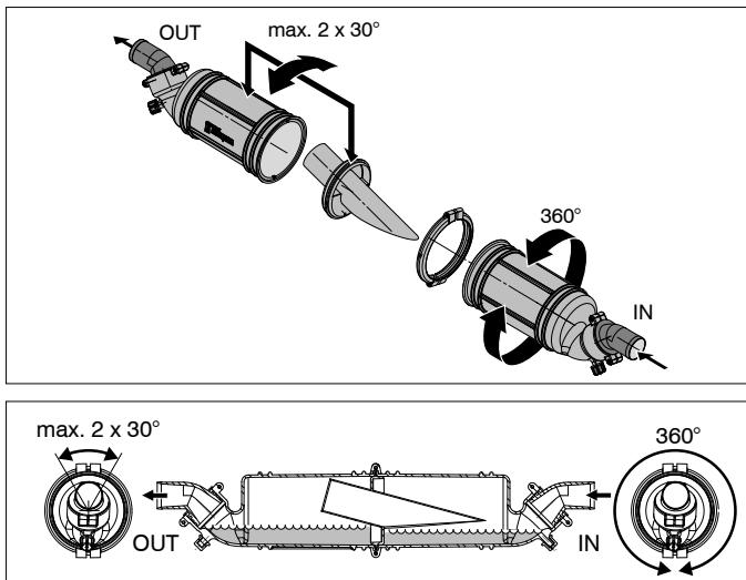
Anche i 2 semicorpi sono ruotabili l'uno rispetto all'altro. Per un buon funzionamento è necessario che il semicorpo OUT (USCITA) e l'elemento al suo interno siano posizionati come indicato nel disegno; è ammessa una rotazione massima di 30° verso entrambi i lati. Il semicorpo IN (INGRESSO) può essere installato in qualsivoglia posizione.
