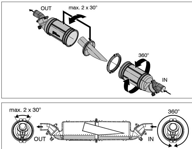
Las 2 mitades de la carcasa se pueden girar entre sí mismas. Para un correcto funcionamiento es básico que la mitad de salida (OUT) de la carcasa y la parte interna colocada dentro de la misma estén en las posiciones relativas que se muestran en la ilustración. Se permite una desviación de un máximo de 30° a ambos lados. La mitad de entrada (IN) de la carcasa se puede colocar en cualquier posición.
